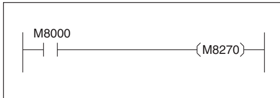
Fig. 12-13 : L'unité de mesure des températures que le FX3U-4AD-PNK-ADP saisit comme 2ième module adaptateur analogique installé, est configuré sur « degré Fahrenheit (°F) ». Le bit interne M8000 est toujours « 1 ».
