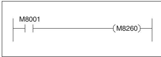
Fig. 12-14 : L'unité de mesure des températures que le FX3U-4AD-PNK-ADP saisit comme 1er module adaptateur analogique installé, est configuré sur « degré Celsius (°C) ». Le bit interne M8001 est toujours « 0 ».
